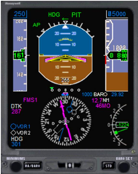
➤ L'écran principal de vol "PFD" regroupe plusieurs instruments de vol (HSI, altimètre, horizon artificiel, variomètre...) sur un seul écran. Cette section décrira tous les éléments de cet afficheur.
