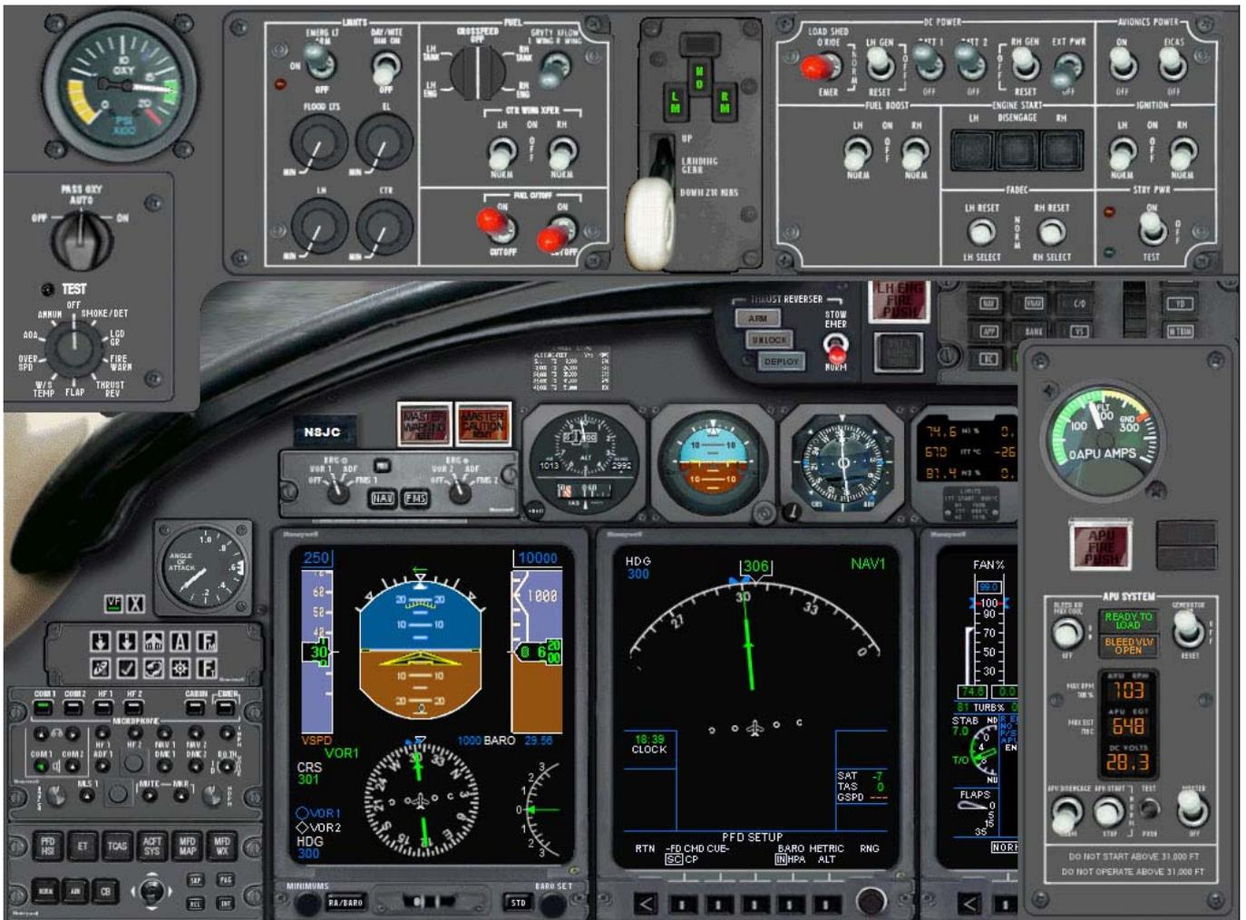
➤ Faire de même pour le moteur gauche. Dès que les deux moteurs sont en marche, couper les boutons **APU Bleed** et **Generator**, puis les interrupteurs **APU Start** et **Master**. Ne pas démarrer le moteur gauche tant que la porte n'est pas fermée et sécurisée.
