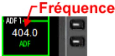
➤ Pour modifier la fréquence de l'ADF, appuyer sur **R3** pour que le rectangle de réglage se positionne autour de la fréquence actuelle. La zone 3 du bouton rond, permet de changer le 1<sup>er</sup> chiffre, la zone 2 changera le 2<sup>ème</sup>, alors que la zone 1 change les 2 derniers chiffres. La fréquence peut être réglée sur n'importe lequel des 2 **RMU**, et elle sera affichée dans les deux.
