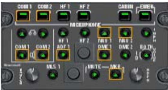
➤ Les boutons actifs sont ceux encadrés en orange. Quand ils ont été activés, un témoin vert s'illuminera au centre du bouton. Il est possible de baisser l'intensité lumineuse de ces témoins à l'aide de l'interrupteur **DIM/BRT** du panneau gauche.
