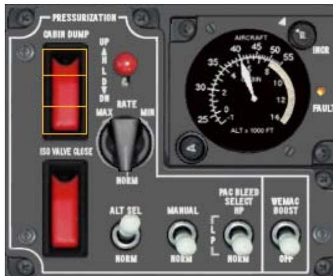
➤ Dans la simulation, le système de pressurisation fonctionne suivant 2 modes: **NORM** et **ALT SEL**.
