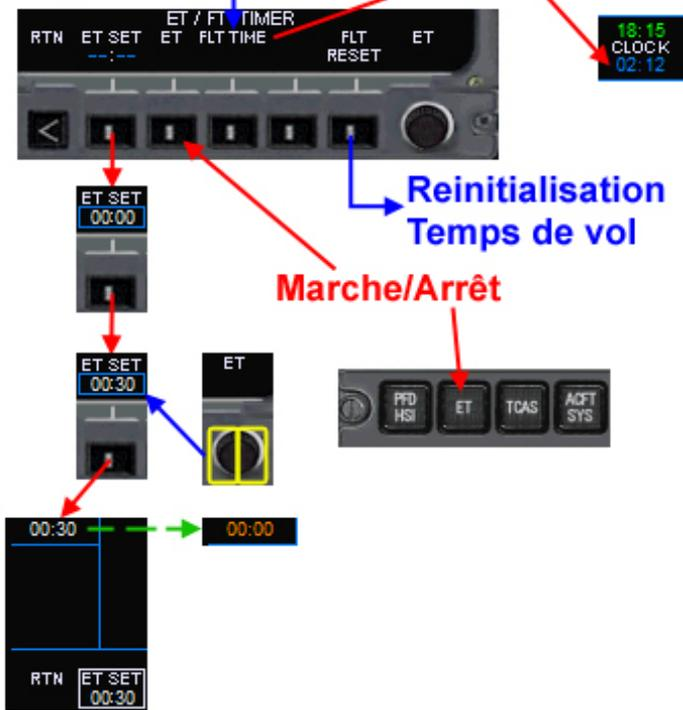
➤ Il y a trois modes de minuterie: un mode chronomètre, un mode temps de vol et un mode compte à rebours.
