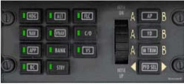
➤ La plupart des fonctions du pilote automatique fonctionnent comme celle de *Flight Simulator*. Je décrirai seulement les fonctions qui diffèrent. L'intensité des témoins lumineux des boutons peut être réduite à l'aide de l'interrupteur **DIM/BRT** du panneau gauche.
