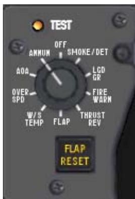
➤ Le bouton de test rotatif est utilisé pendant la visite pré-vol pour tester les différents systèmes et témoins lumineux de l'avion. Chaque position du bouton provoque l'apparition de différents phénomènes lumineux et sonores. Ceux-ci sont listés ci-dessous ainsi que les messages CAS associés qui s'affichent sur l'écran EICAS.
