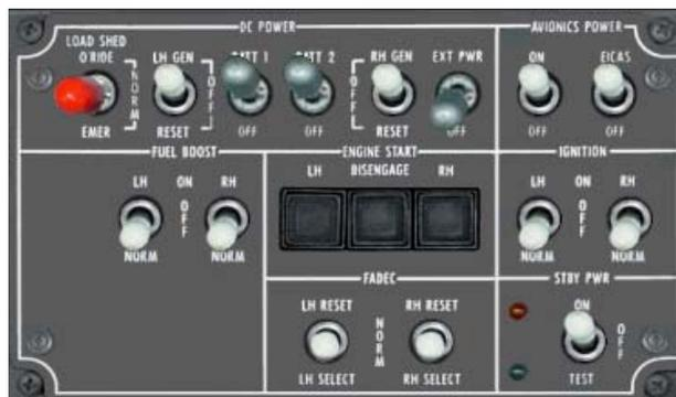
➤ Les boutons **AVIONICS POWER** fonctionnent simultanément. Les commutateurs **AVIONICS POWER** doivent être actionnés pour que le **HSI (Horizontal Situation Indicator)** de secours fonctionne.
