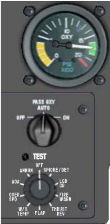
➤ Le système d'oxygène consiste en un cadran et un bouton de sélection. Le cadran indique la pression dans la bouteille en centaine de PSI. La pression normale est indiquée par la plage verte. Si la bouteille ne vient qu'à être vide, vous pouvez la reconditionner en ayant auparavant serré le frein de parking, régler les moteurs à un N2 inférieur à 10% et l'avion doit être au sol. Ensuite, il faut placer le bouton sur **OFF**, et un mécanicien remplira la bouteille d'oxygène.
