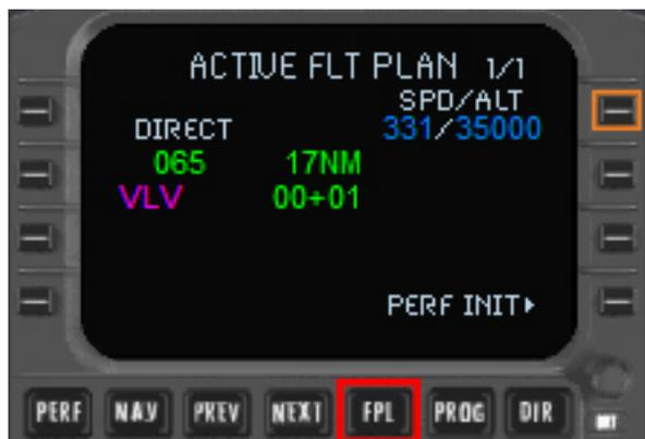
➤ La page du plan de vol consiste en une seule page montrant les informations du point de passage **GPS** actuel. Le champ **SPD/ALT** montre la vitesse et l'altitude du **PA**. Ces deux valeurs peuvent être changées en utilisant le **SCRATCHPAD** et la touche **R1**. Un chiffre inférieur à 1000 sera interprété comme une vitesse, alors qu'un chiffre supérieur à 999 sera interprété comme une altitude.
